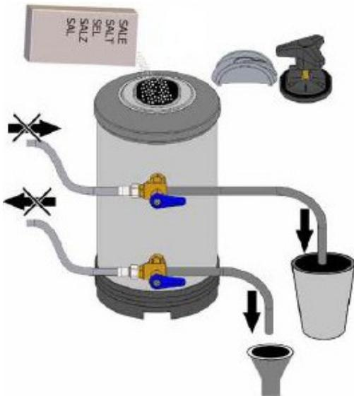
*Regenerierung (Hebel „C“ nach links, Hebel „D“ nach rechts)*
