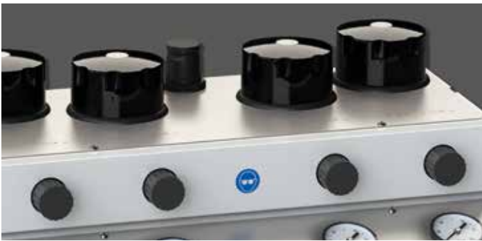
Strahlkammern mit individuellem Arbeitsdruck, 0,8–6 bar
