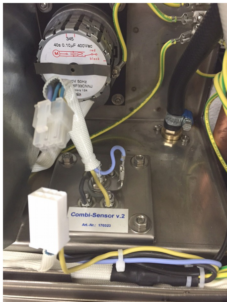
Sensor Stecker (6-polig) abziehen
