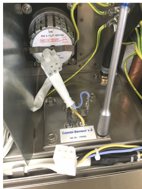
(4x M5) Muttern lösen
